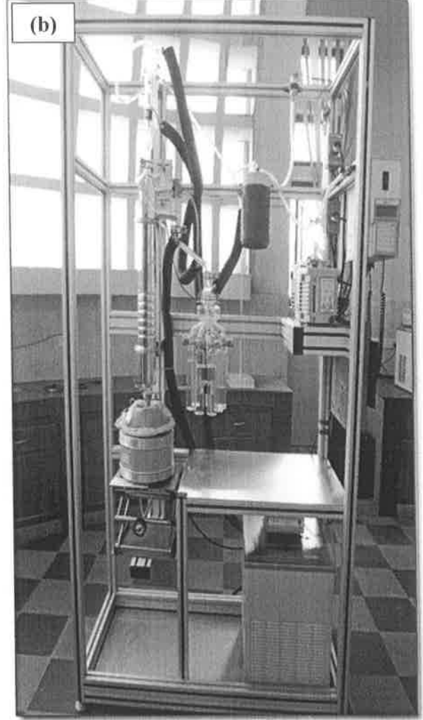
(a) उच्च दाब-उच्च तापमान (एचपीएचटी) रिएक्टर। (b) वास्तविक उबलने का समय (टीबीपी) आवसन इकाई। (c) "बायोक्रूड आसव"
